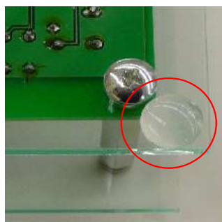
⑤底面の四隅に「ゴム足」を貼り付けたら完成です(4カ所)
