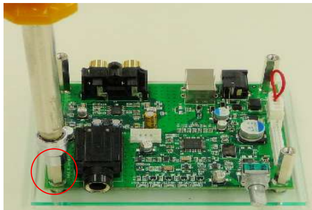
④もう1枚のアクリル板を乗せて「六角穴つきネジ」で固定します(4カ所)
