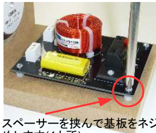
2.5mmのドリルで貫通穴を開け ます(4カ所)
