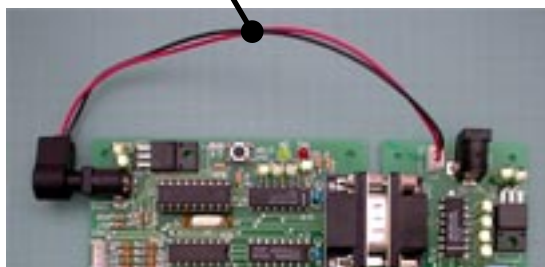
写真4：電源送りハーネスの接続
