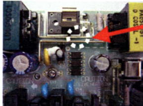
写真1.1 不具合の部位例(銅バーのSnめっき部)
